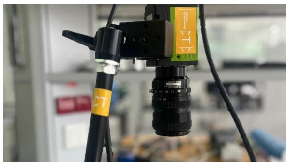
CTC ha adquirido recientemente una cámara industrial de prisma multiespectral que proporciona imágenes simultáneas de diferentes bandas espectrales.
